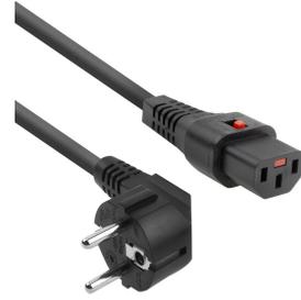
ACT Netsnoer CEE 7/7 male (haaks) - C13 IEC Lock zwart 3 m, EL234S, 5-Pack. Snoerlengte: 3 m, Aansluiting 1: CEE7/7, Aansluiting 2: C13 stekker, Soort kabel: H05VV-F. Ingangsspanning: 250 V, Stroom: 10 A
